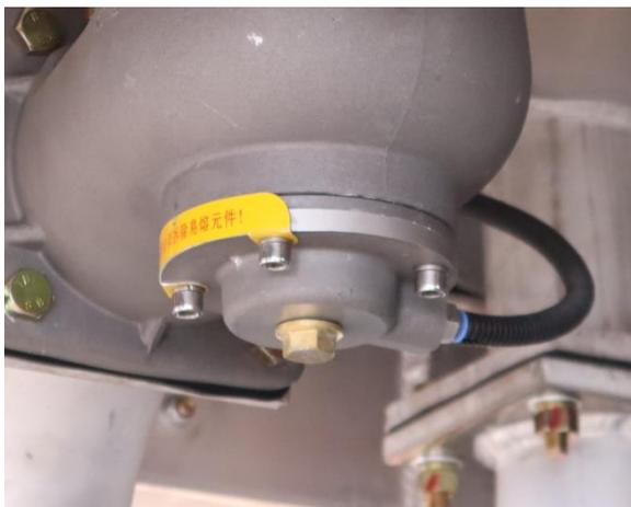
2. 拆除罐体底部海底阀（紧急切断阀）底部易熔螺栓（易熔螺栓的易熔温度为  $75 \pm 5^{\circ}\text{C}$ ），再安装与原易熔螺栓同规格长度螺栓，顶开海底阀便于蒸罐时流出废液。
